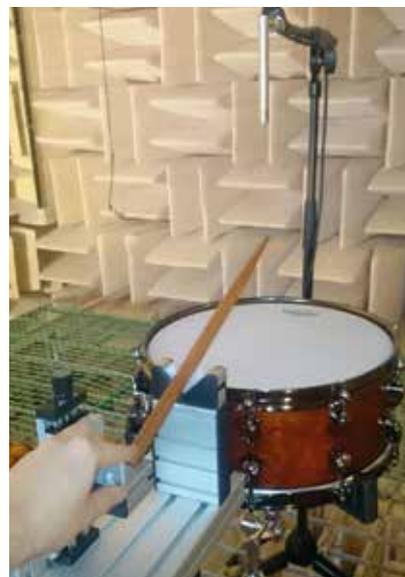
▲ Überprüfung der Messverfahren durch Vergleich am realen Instrument
